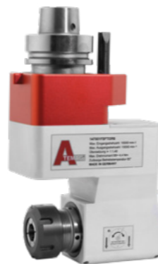
EXTRA Schlosskasten fräsen. Doorlock recess.
